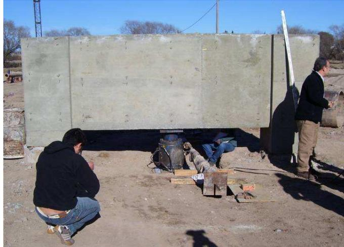
**Figura 11.** Viga de reacción y gato hidráulico utilizado en el ensayo de carga estático del Pilote N°8
