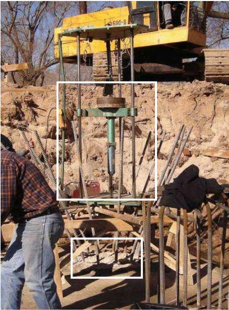
**Figura 9.** Ensayo dinámico del pilote
