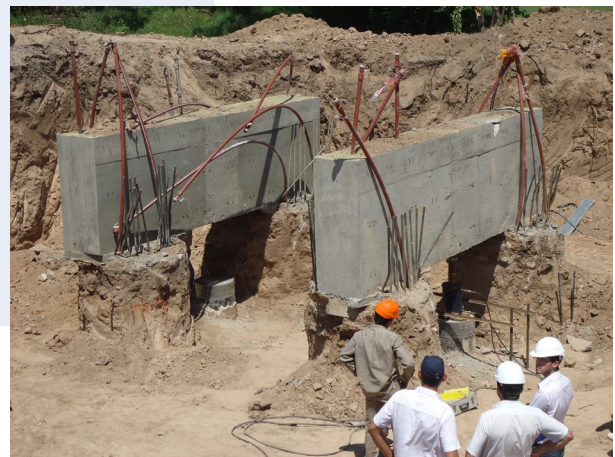
Prueba de carga de los pilotes
