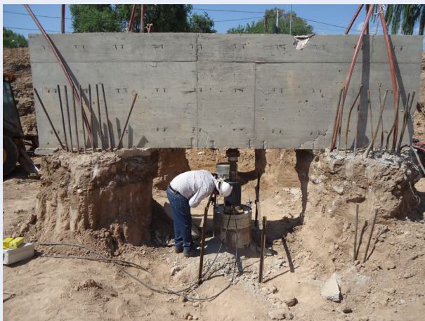
Prueba de carga de los pilotes
