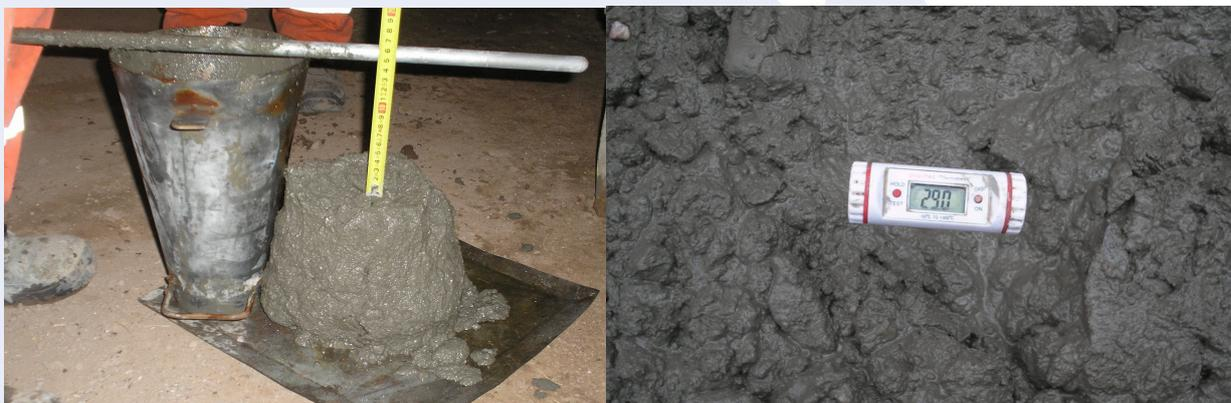
**Figura 9. Controles durante el hormigonado**
