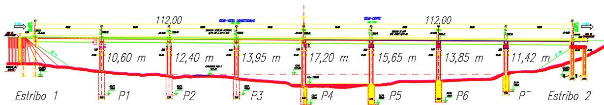
Figura 5: Vista longitudinal del puente bajo estudio
